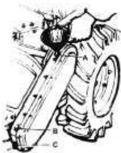
Fig. 20 Pontos de abastecimento de óleo e bujões para inspeção de nível de óleo e de drenagem de óleo da enxada rotativa.
