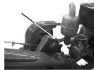
Fig.18 Ponto de abastecimento de óleo da caixa de engrenagem de direção e caixa de direção.
