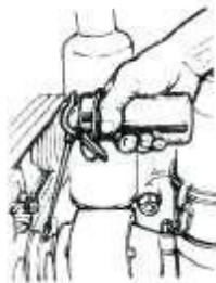
Fig.17 Lubrificação da alavanca da embreagem
