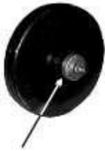
Fig.16 Lubrificação do cubo e eixo da roda de ferro da enxada
