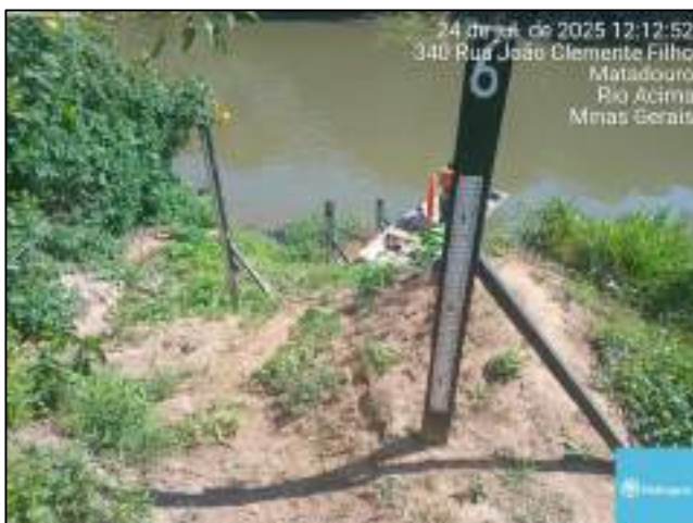
Figura 8 - Régua s da estação Rio Acima
