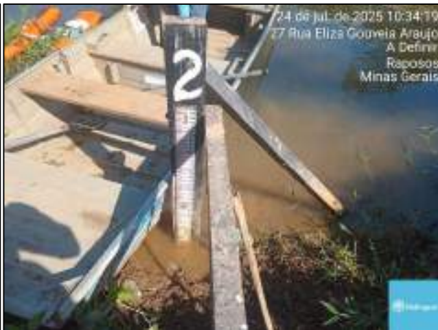
Figura 6 - Cota durante a medição na estação Raposos em 24/07/25
