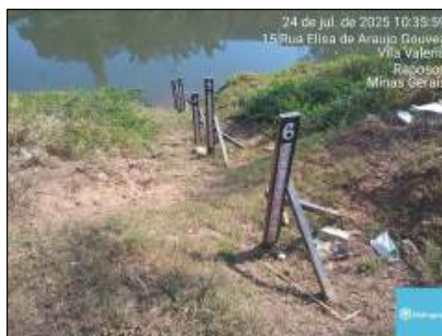
Figura 4 - Réguas s da estação Raposos
