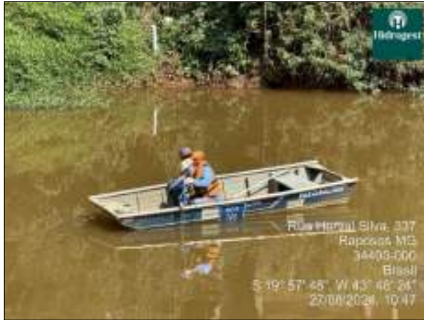
Figura 5 - Medição de descarga líquida estação Raposos – 27/08/24
