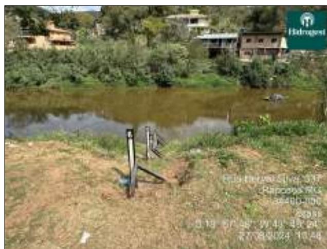
Figura 4 - Régua s da estação Raposos
