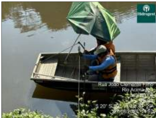
Figura 9 - Medição de descarga líquida estação Rio Acima - 27/08/24
