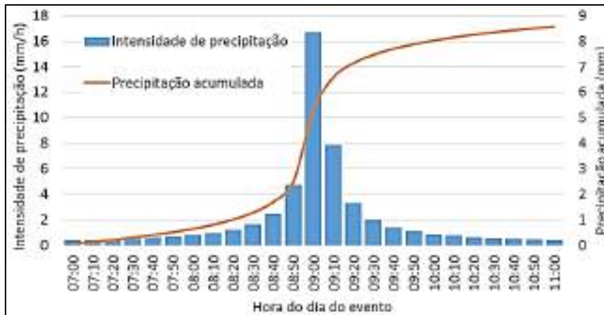
Exemplo de hietograma sintético. Demonstração da distribuição por meio do método de blocos alternados de evento de 8,57 mm acumulados em 4 horas. (Fonte: https://www.researchgate.net/figure/Figura-35-Exemplo-de-hietograma-sintetico-Demonstracao-da-distribuicao-por-meio-do_fig19_313854924 )
