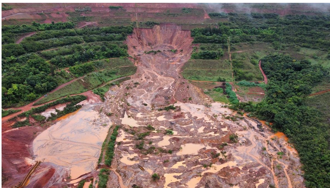
Deslizamento da Pilha Cachoeirinha da Mina Pau Branco, da Vallourec, devido às chuvas intensas (209 mm em 24 horas) do dia 8 de janeiro de 2022
